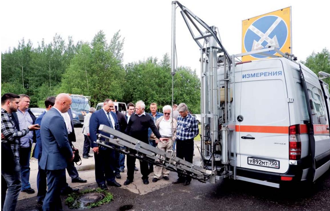
Передвижная дорожная лаборатория оценки состояния дорог, созданная в МАДИ
